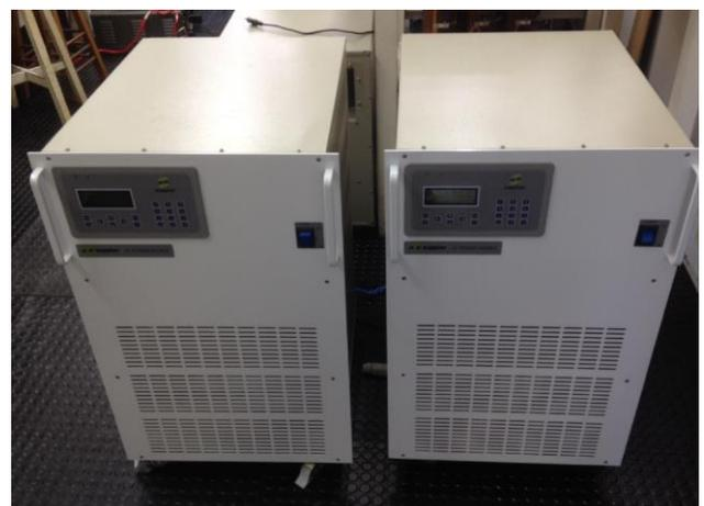
Figura 14. Conversores comerciais da Supplier, empregados no sistema de emulação da microturbina.
