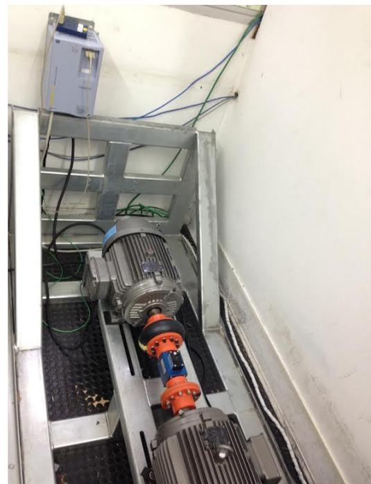
Figura 13. Bancada de emulação de energia eólica, composta por duas máquinas de ímãs permanentes, um inversor de frequência e um torquímetro de precisão.
